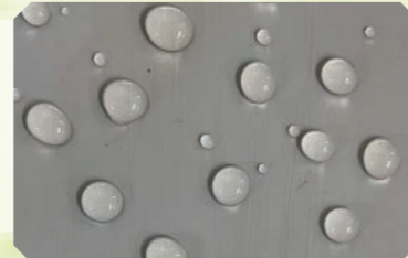
バッファークコートは撥水塗膜を形成し、外部からの水分の侵入を防ぎます。
