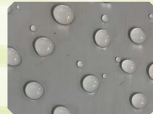
バッファークコートは撥水塗膜を形成し、外部からの水分の侵入を防ぎます。
