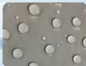
バッファークートDは撥水塗膜を形成し、外部からの水分の侵入を防ぎます。
