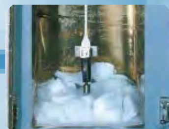
耐寒性試験の様子。 -50℃から200℃の範囲で塗膜変化がなく、低温での施工が可能です。
